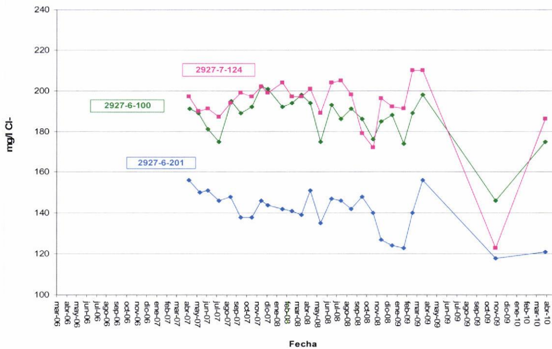
EVOLUCIÓN DEL CONTENIDO EN CLORUROS- MAS 80.141 PLANA DE VALENCIA NORTE Sector Vinalesa-Museros
